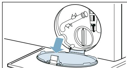
3. Выньте сливной шланг из держателя. Снимите колпачок и дайте воде стечь в подходящую ёмкость. Установите колпачок на место и поместите сливной шланг в держатель.
